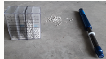
Je kan de kwaliteit van de meststof meten met een fractie- en een hardheidsmeter.
