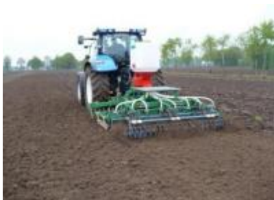
Figuur 1: Gras zaaien met zaaibak op cultivator (bron LCV vzw)
