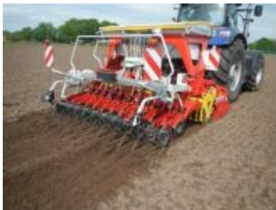
Figuur 3: Zaaicombinatie gelijktijdig maïs en gras zaaien (bron: LCV vzw)
